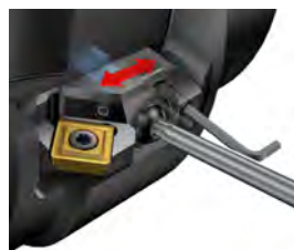
СС – осевая регулировка, обработка фаски
